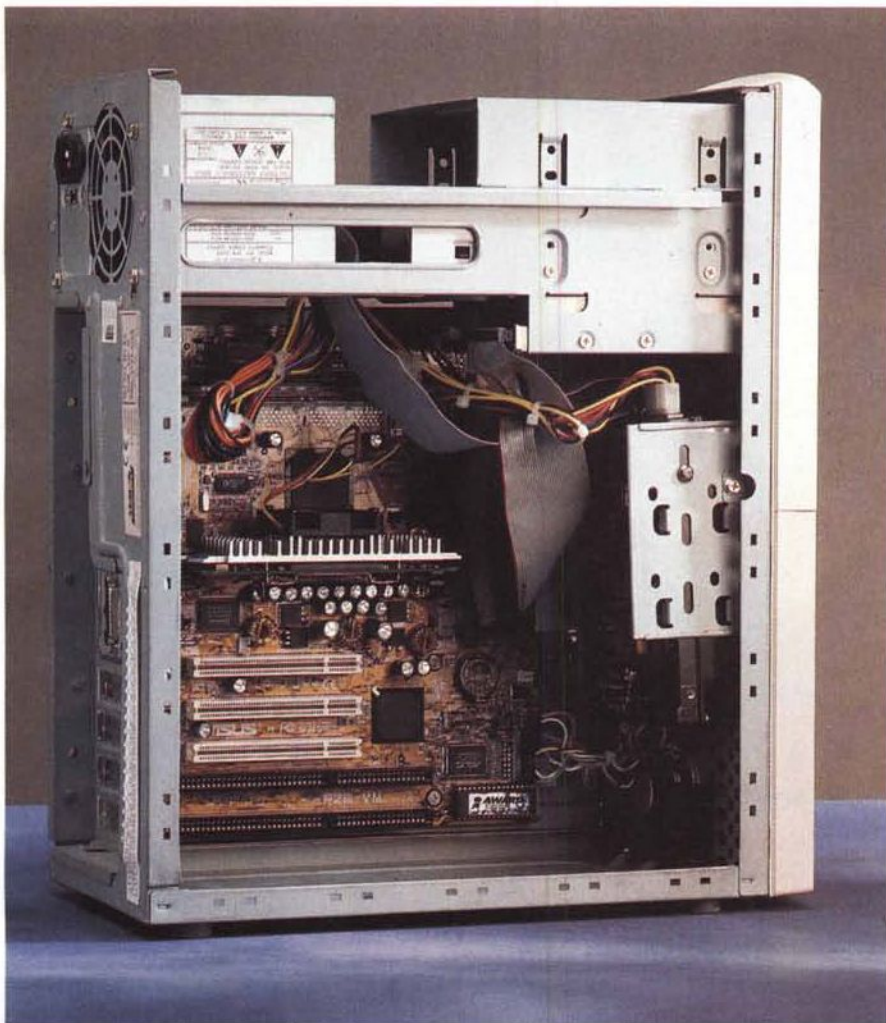
L'interno dello chassis con la scheda micro-ATX Asus P2E-VM, sulla quale trovano posto il Celeron 266, chipset Intel 440EX AGP e 32 MB di SDRAM. Si noti la singolare installazione in verticale del disco rigido.
